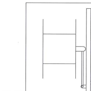
L'élément doit toujours être monté dans l'arête
